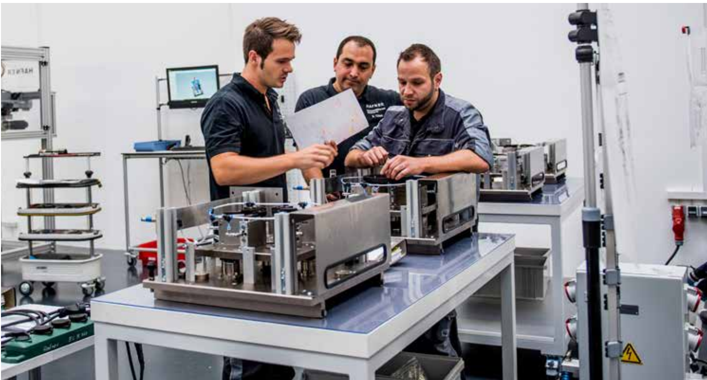
Hafner-Mitarbeiter bei der Feinabstimmung an einer Messstation für Gelenkstücke aus der Seitenwelle.
